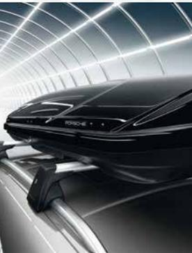
Abschließbare Kunststoff-Box in Schwarz (hochglanz) mit ca. 520 Liter Volumen und integriertem Skihalter. Beidseitig zu öffnen (Länge 2.180 mm, Breite 895 mm, Höhe 400 mm). Artikelnummer: 958 044 000 12
