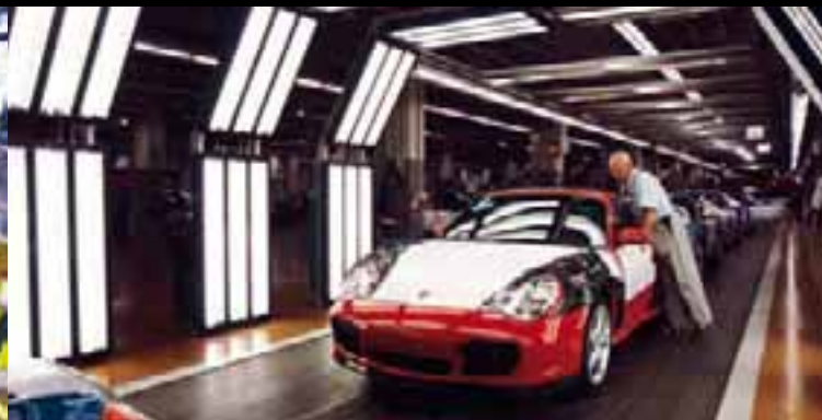
Im Lichttunnel wird die Lackierung geprüft.
