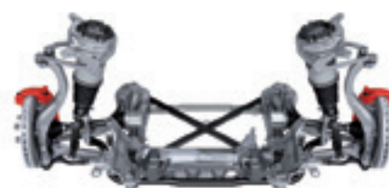
Luftfederung mit Porsche Active Suspension Management (PASM) im Porsche Macan
